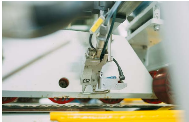
Ambalaj üreticisi Solpap'ta SpeedUp katlama sıvısının uygulaması.
