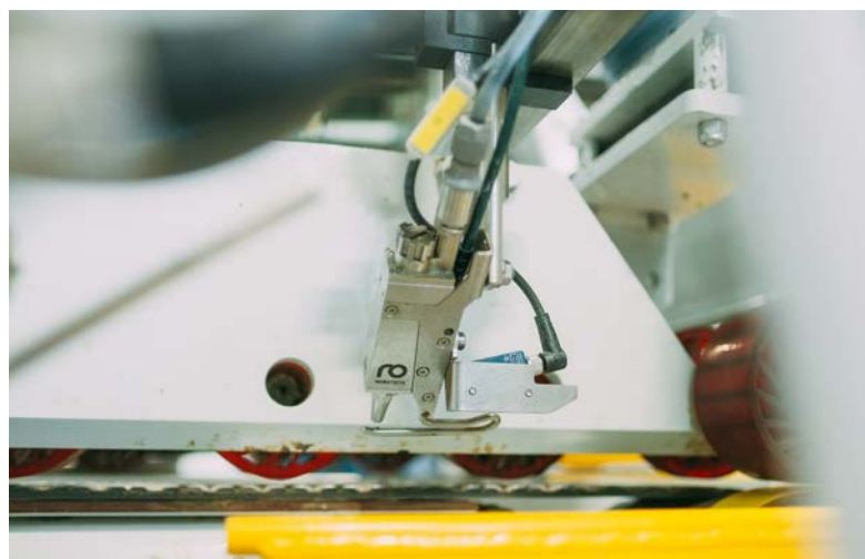
Applicazione del liquido per cordonatura SpeedUp presso il produttore di materiali da imballaggio Solpap.
