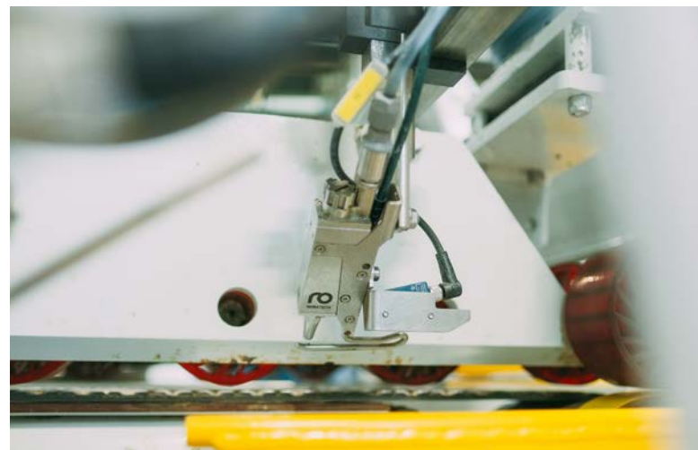
Aplicación del líquido de plegado SpeedUp en el fabricante de embalajes Solpap.
