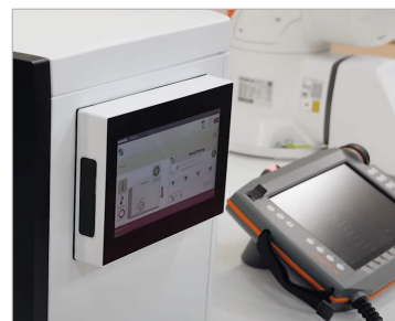
Obsługa na panelu urządzenia do topienia lub zdalna
