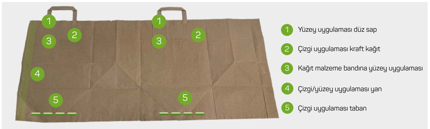
Kağıt taşıma torbası üretimi için soğuk tutkal uygulamasında istasyonlar
