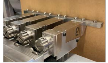
Presto 165 mm uygulama genişliğine kadar çoklu başlık olarak
