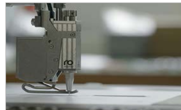
Sempre、底面および側面の接着のためのビード塗布
