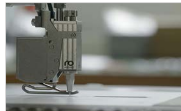
Sempre para la aplicación de cordones para el encolado de la base y de los laterales
